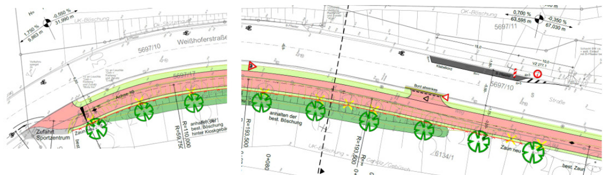
Der geplante Ausbau des Rad- und Gehwegs entlang der L 1103a und B 35 in Richtung Knittlingen erfordert in dem dargestellten Bereich Eingriffe in den Baumbestand. Insgesamt müssen 21 Bäume weichen. Foto: RP Karlsruhe/ Mailänder Consult
