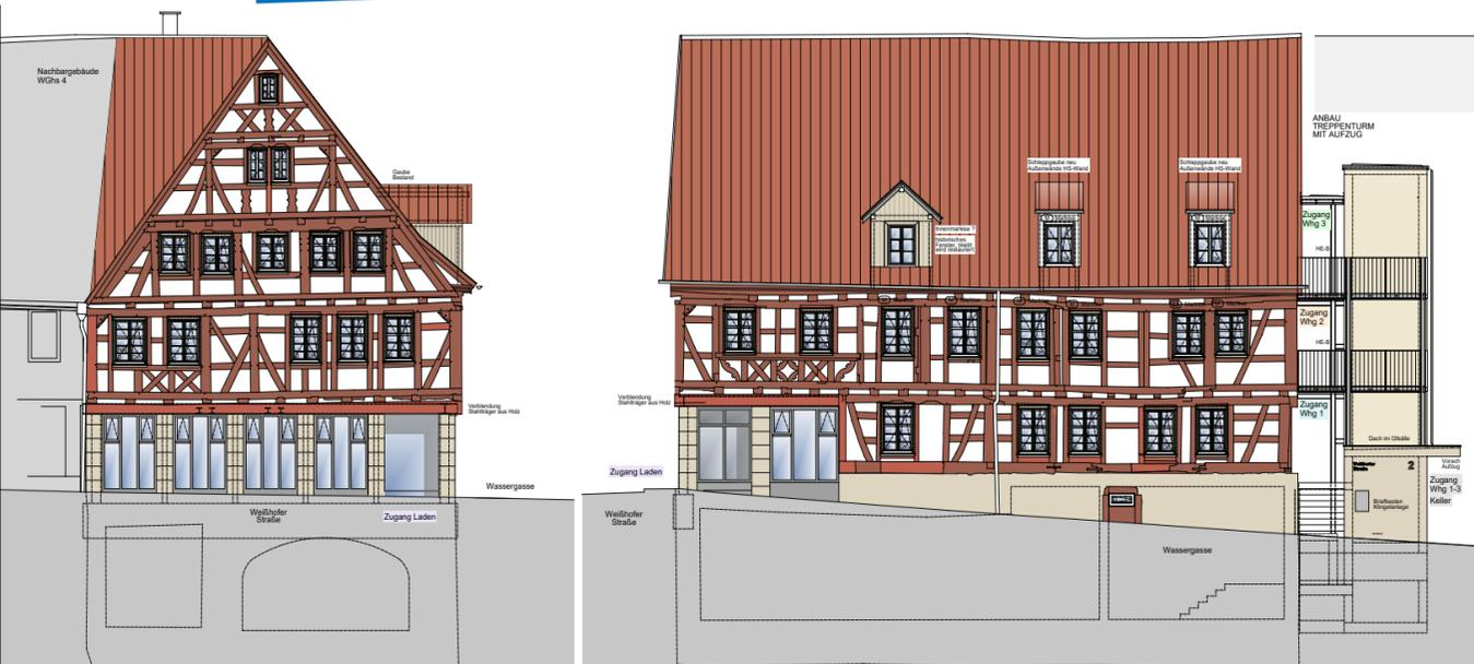
Die Sanierung sieht eine Wiederherstellung der ursprünglichen Fachwerkfassade zum Marktplatz hin (Abbildung links) und zur Wassergasse (Abbildung rechts) vor sowie die Entfernung des Anbaus aus dem Jahr 1971, an dessen Stelle ein filigraner Stahlbau mit Aufzug entstehen wird.
