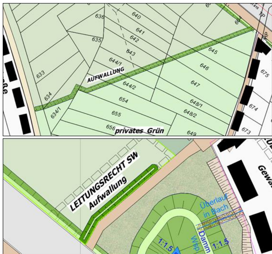
Abbildung 4: Aufwallung (ca. 50 cm) zwischen Wohnbauflä- chen und privaten Gra- belandflächen bzw. zwi- schen Wohnbauflächen und Regenrückhaltebe- cken (Teilbereich Obere Krautgärten – 1. Ände- rung).
