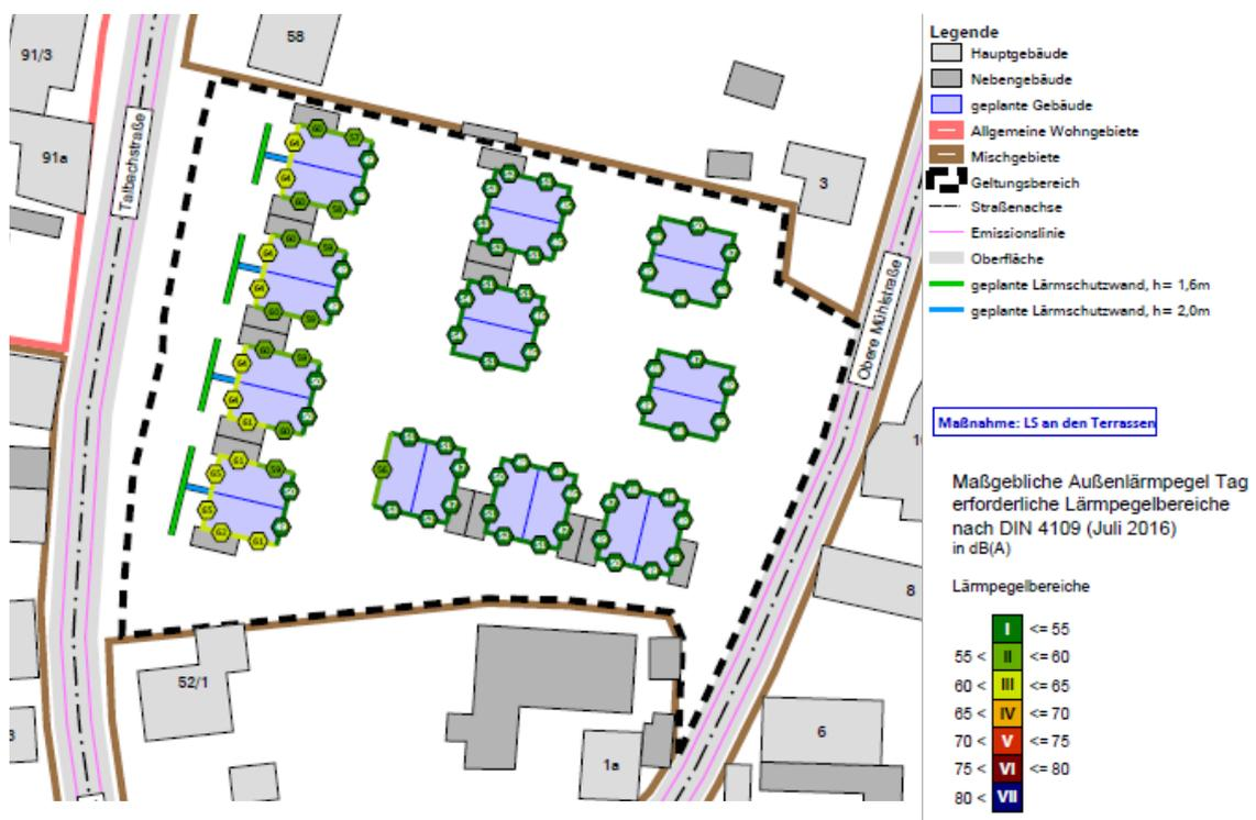
Abb.: Maßgeblicher Außenlärmpegel Tag an Fassaden der Planung mit Lärmschutz nach DIN 4109-2; reale Schallausbreitung
