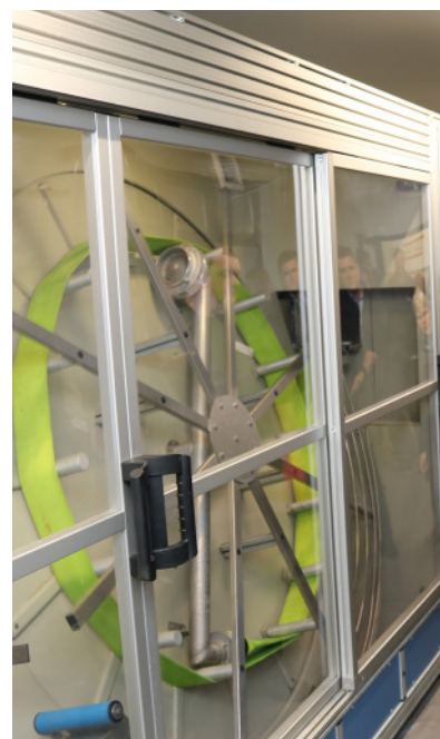
In der neuen Anlage werden Feuerwehrschräume gewaschen, geprüft und mit Druckluft getrocknet.
